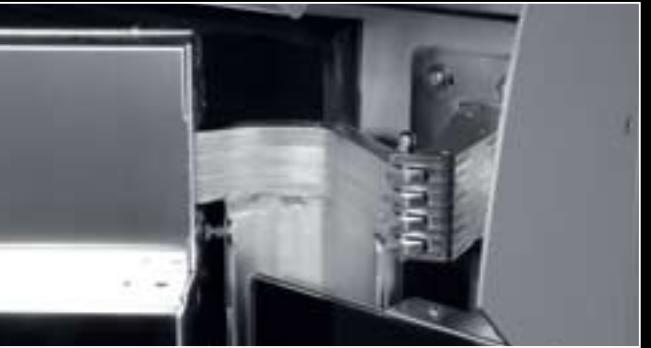
La campana, de línea integrada con el perfil del horno, se eleva con la apertura de la puerta aumentando el área de aspiración propia en el momento de máxima necesidad.
