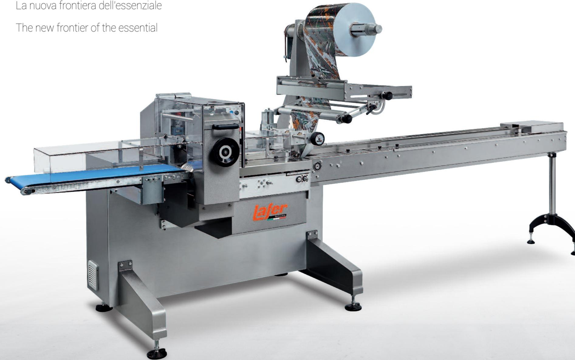
Confezionatrice orizzontale a tre assi elettrici brushless studiata appositamente per applicazioni con caricamento manuale dei prodotti, con gli stessi punti di forza delle macchine Laferpack di alta gamma: esecuzione a sbalzo; touch screen a colori da 7 pollici con interfaccia intuitiva; completo accesso all'area operativa della macchina.
