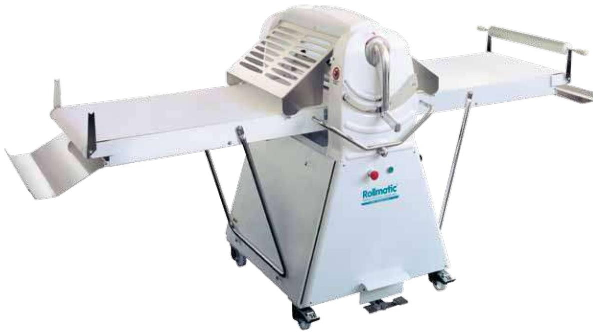
Sfogliatrice manuale su base con ruote. Tavoli ripiegabili ed estraibili. Inversione del ciclo di lavoro con barra e pedaliera, protezioni cilindri in inox con micro di sicurezza e molla a gas. Disponibile in versione con inverter e unità di taglio
