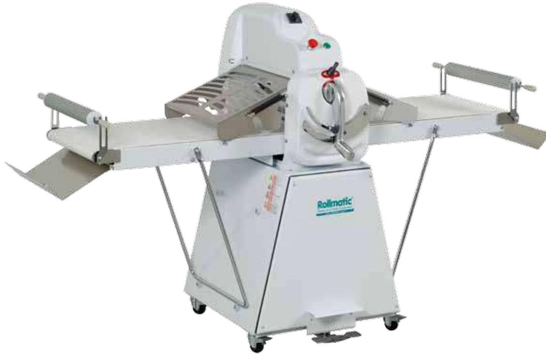
Sfogliatrice compatta su base con ruote e tavoli ripiegabili. Inversione del ciclo di lavoro con joy-stick e pedaliera(opzione), protezioni cilindri in inox con micro di sicurezza e molla a gas
