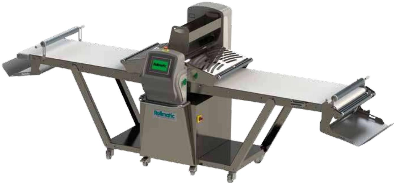
Sfogliatrice su base con ruote, in acciaio inox e totalmente automatica, disponibile anche in versione con sistema di taglio. Sfarinatore e avvolgitore automatici. Touch screen da 7" con 100 programmi di lavoro. Protezioni dei cilindri con micro di sicurezza e molla a gas. Cassetto farina con micro di sicurezza
